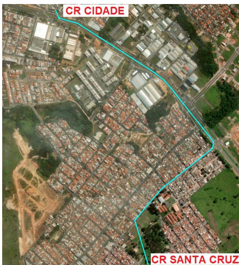
Figura 1 - Encaminhamento da tubulação de adução
