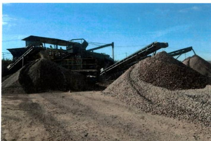
*Figura 41- Material Agregado Reciclado. Fonte CSO Ambiental, 2019*
