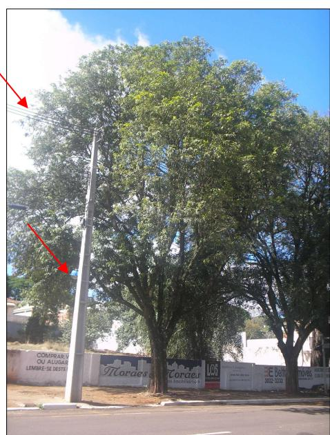
Figura 4. Adaptação do meio urbano em função das árvores na cidade de Maringá, PR. Árvore da espécie Alecrim de Campinas sem podas e com fiação primária compacta e iluminação rebaixada (setas vermelhas).
