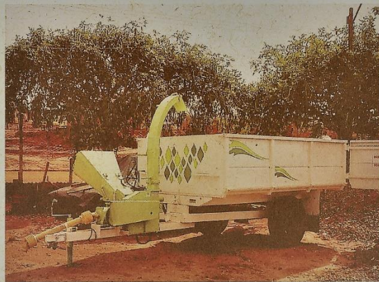
FIGURA 2 - EQUIPAMENTO PARA PICAR GALHOS RESULTANTES DE PODAS DE ÁRVORES. Fonte: WOLMER / CETESB, 2008.
